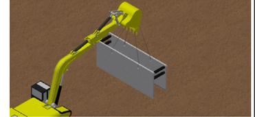
4) PLACE SLING IN TOP 4 LIFT LUGS. STAND SHIELD IN UPRIGHT POSITION AND PREPARE FOR INSTALLATION.
