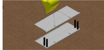
3) CONNECT SLING TO 4 LIFTING EYES OF TOP SIDEWALL. REMOVE SPREADER PINS FROM THE UPPER PORTION OF THE SPREADERS. LIFT THE TOP SIDEWALL FROM THE SPREADERS.
