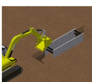
2) CONTINUE EXCAVATING WITHIN SHIELD WHILE PUSHING DOWN ON SHIELD CORNERS UNTIL PROPER GRADE IS REACHED.
