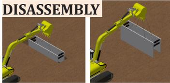
1) PLACE OSHA APPROVED SLING IN TOP 4 LIFT LUGS. STAND SHIELD IN UPRIGHT POSITION AND LIFT BOX FROM EXCAVATION. WARNING: LIFT LUGS ARE INTENDED FOR LIFTING ONLY.
